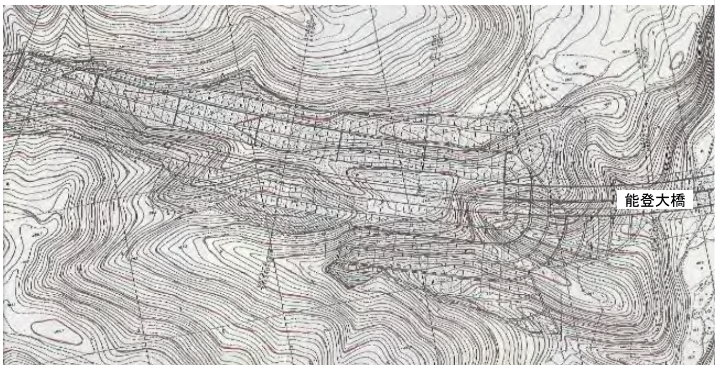
橋台背面盛土部に複数の沢が存在 出典:石川県道路公社提供資料
