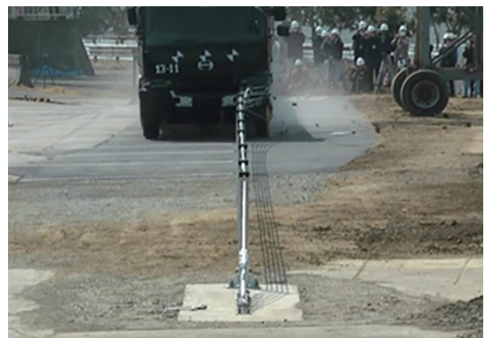
ワイヤロープ式防護柵の衝突試験 (平成 26 年)
