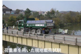
荷重車を用いた現地載荷試験
