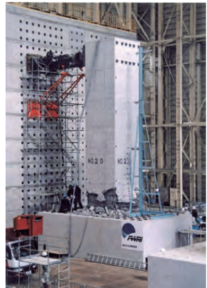
写真-1.1.1 実大RC橋脚に対する正負交番繰返し载荷実験
