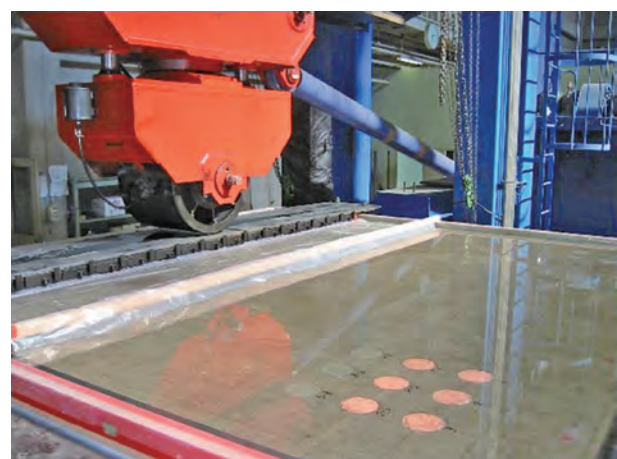
写真-3.2.3 SFRC 舗装の水張り状況下での輪荷重走行疲労試験
