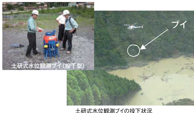
写真-1.2.1 土研式水位観測ブイ(投下型)の外観と設置の様子(平成23年9月9日撮影)
