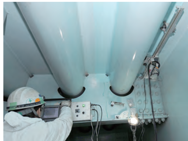
写真-3.2.2 開発した超音波探傷装置の現場試行
