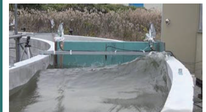
河川津波遡上実験による構造物への影響把握
