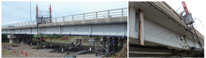
耐荷力評価手法の構築のため国内初の実橋PC主桁の破壊試験を実施（橋梁）
