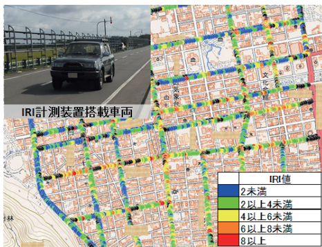
舗装の維持修繕箇所の簡易な抽出方法を検討（IRI値の活用）（舗装）
