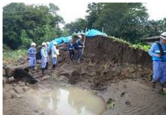
写真-3 決壊箇所周辺の痕跡水位、基礎地盤、堤体 の土質構成等の確認
