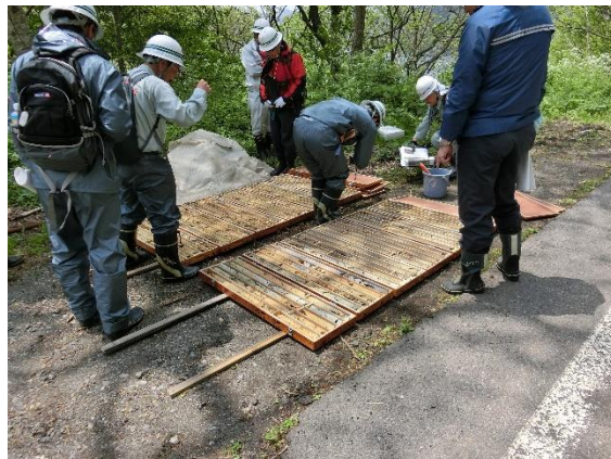
写真-2 土砂崩落斜面周辺のボーリングコアの確認
