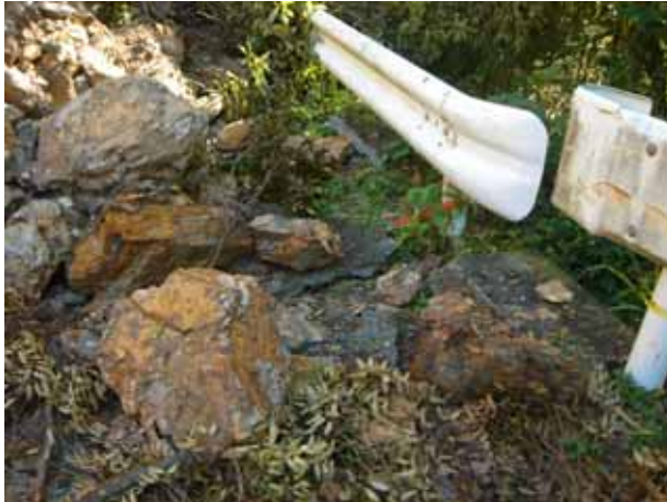
写真 -10 崩壊頭部の状況。強風化・破碎質の泥質岩や砂岩からなる。層理面構造が不均質でありメランジェか。
