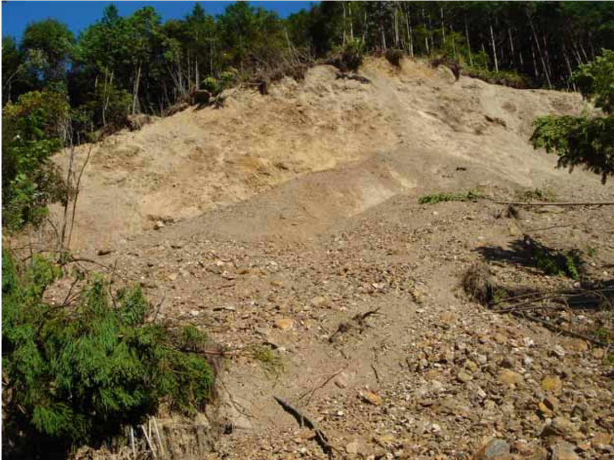
写真 -10 崩壊頭部の状況。強風化・破碎質の泥質岩や砂岩からなる。層理面構造が不均質でありメランジェか。
