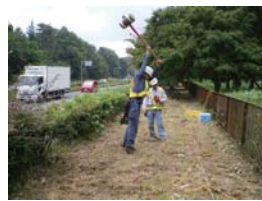
土研西大通り沿い敷地境界でのハイブリッド表面波探査実施風景
