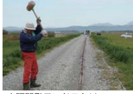
土研開発ランドストリーマーを利用した表面波探査の実施例
