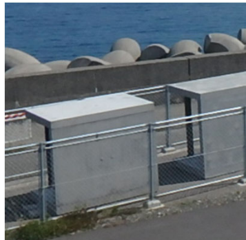
シラン系表面含浸材 暴露実験5年において 塩分浸透の低減効果を確認
