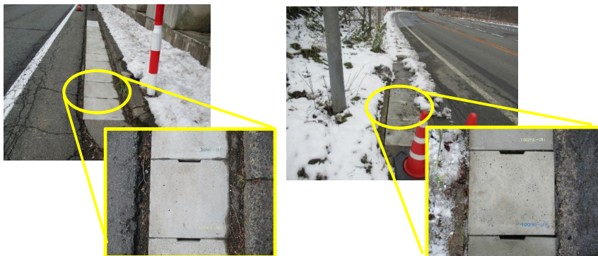
凍結防止剤散布地域での暴露試験（東北14箇所）
