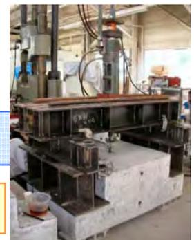
あと施工アンカーの引抜き試験
