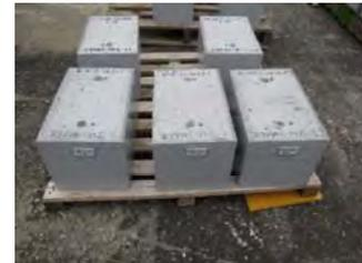
現地暴露用供試体(181体) 実際の下部工に使ったコンクリートと同じ材料・同じ配合
