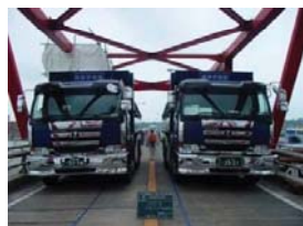
荷重車載荷試験
