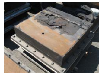
橋梁から取り外した 後のゴム支承破断 面の状態
