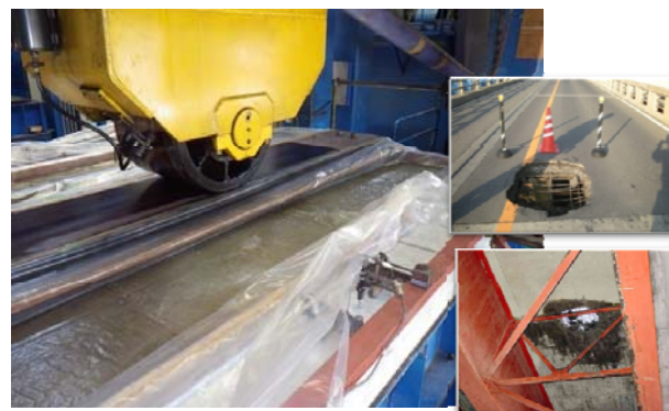
RC床版の輪荷重走行試験
