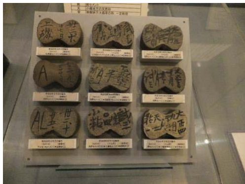
100年分のコンクリートのテストピース (6万個) 一種の長期モニタリング
