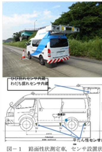
図-1 路面性状測定車、センサ設置状況
