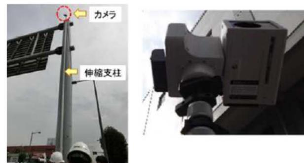
カメラ等による支柱上部の変状確認調査
