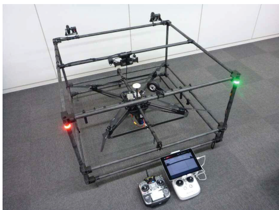
床版点検用ドローン さいたま見沼地区で試行
