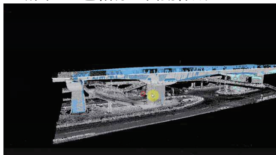
点群から面を自動作成、3D-CADモデル化
