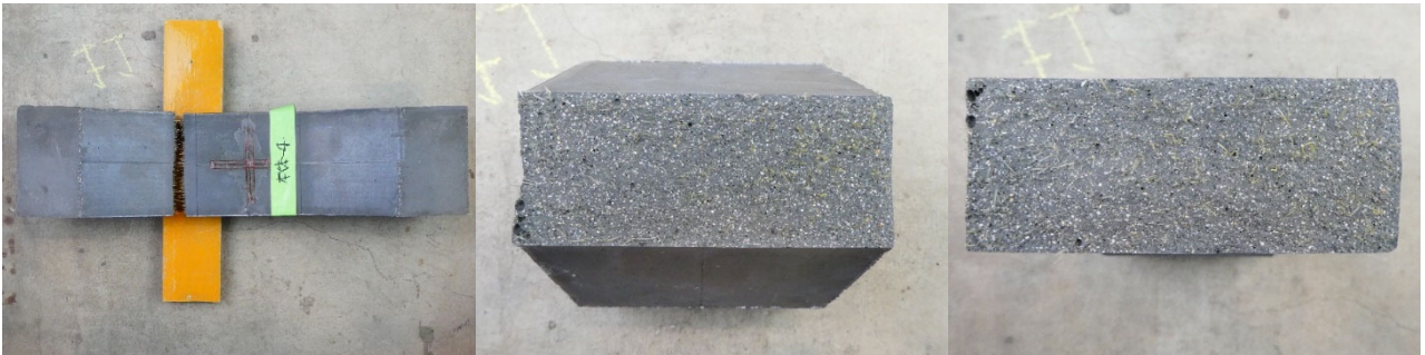
(b)床版-4 の側面と破断面
