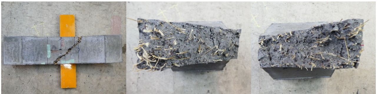
(c)はり (間) -2 の側面と破断面
