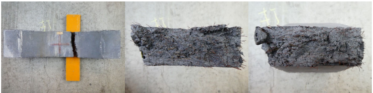
(b)床版 (大) -1 の側面と破断面
