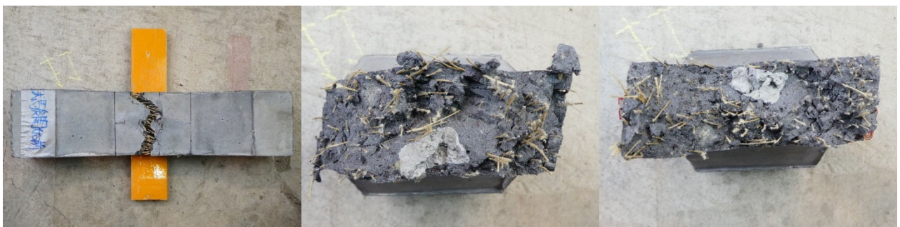
(c)床版 (間) -2 の側面と破断面
