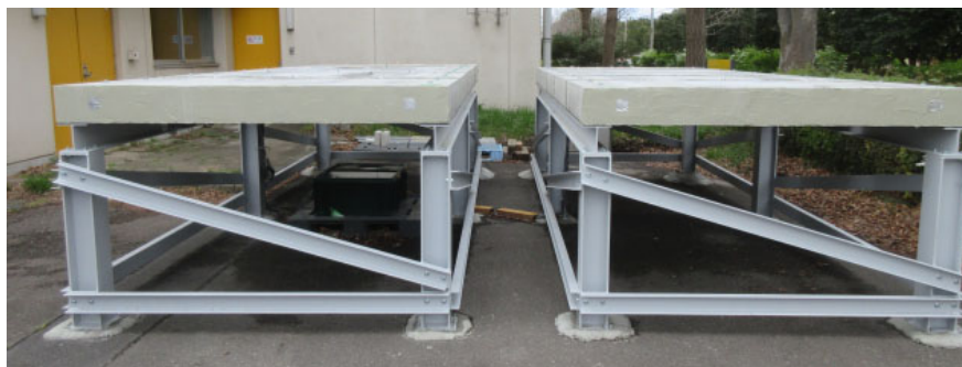
左側：ブレーカー等によるはつりを行った試験体， 右側：ウォータージェットによるはつりを行った試験体
