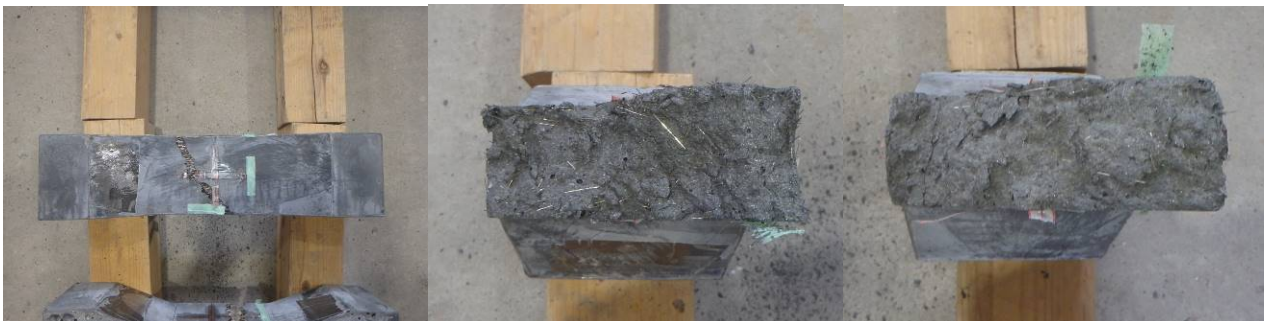
(d) PCa-3 の側面と破断面
