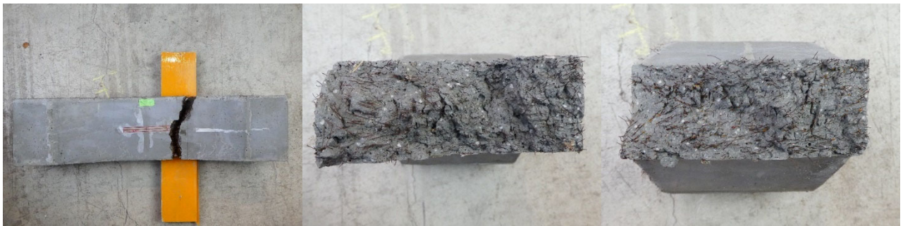
(b)床版(間) -4 の側面と破断面
