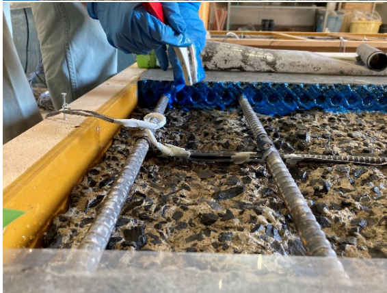
図-1.2.5.3 エポキシ接着剤の塗布状況 (KJ)
