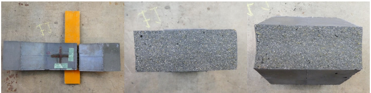
(b)はり-1 の側面と破断面
