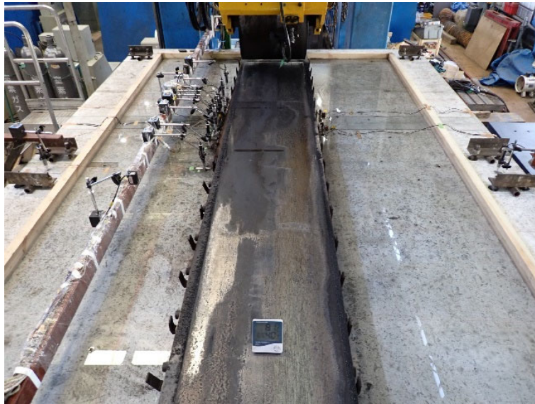
写真-1 水張り状況
