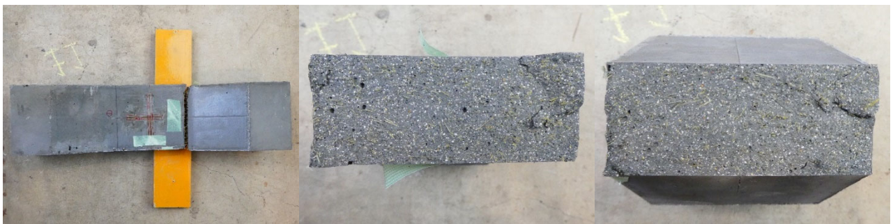
(d)はり-3 の側面と破断面
