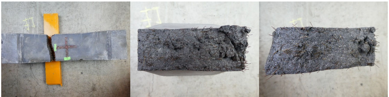
(c)床版 (小) -5 の側面と破断面
