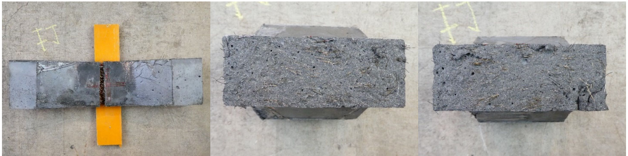
(b)補修材-1 の側面と破断面
