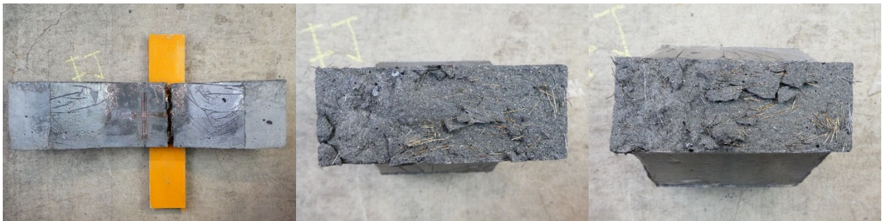
(d)補修材-3 の側面と破断面
