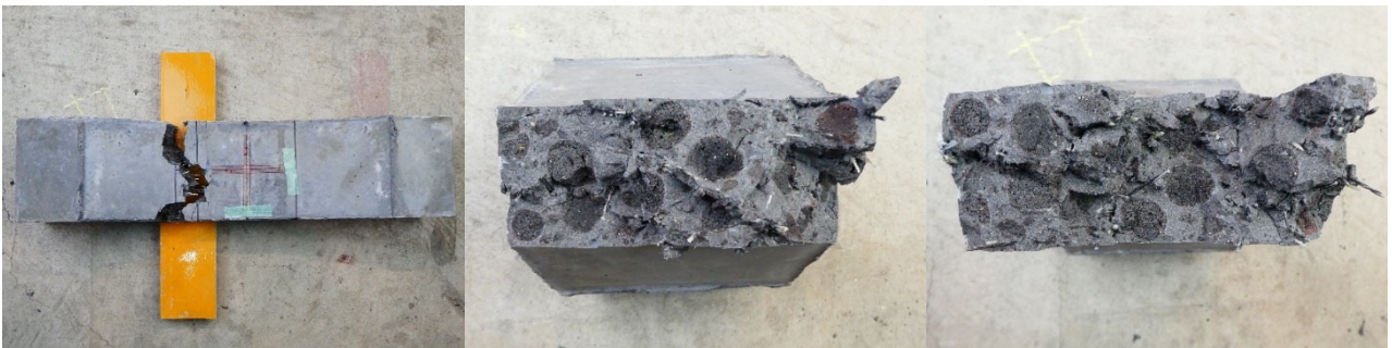
(d)はり-3 の側面と破断面
