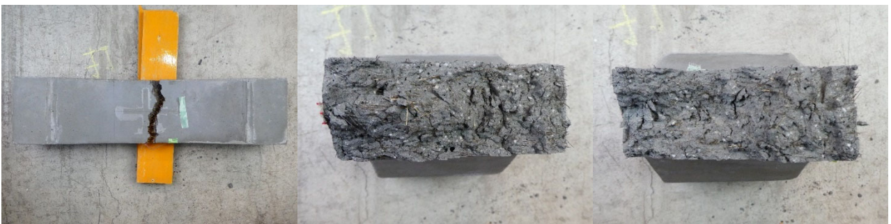
(d)はり(間)-3の側面と破断面
