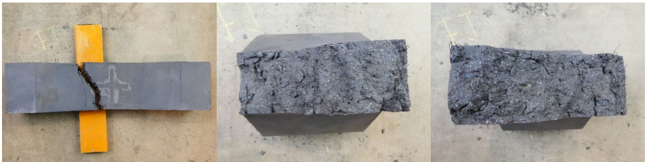
(b)はり (間) -1 の側面と破断面
