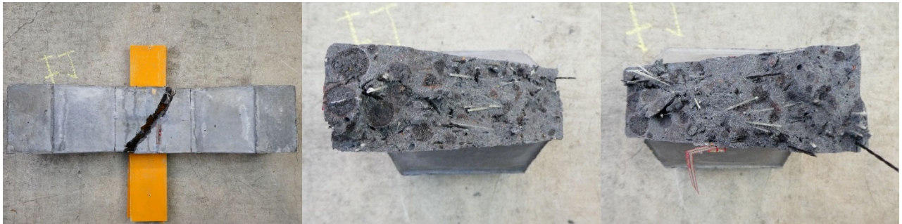
(b)床版-4 の側面と破断面
