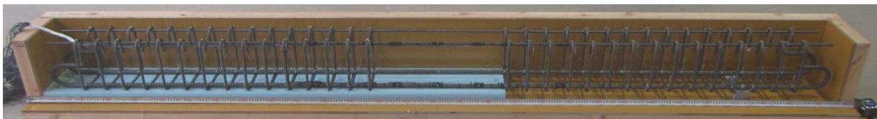
(c)供試体 C(支間中央から 250mm, 補修深さ 40mm)
