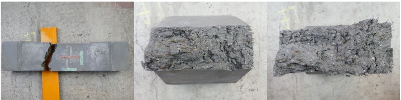
(b)はり(間)-1の側面と破断面
