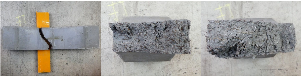
(b)床版(間)-1の側面と破断面
