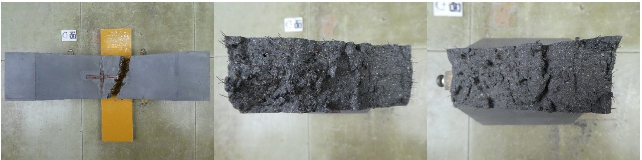
(b)はり-1 の側面と破断面
