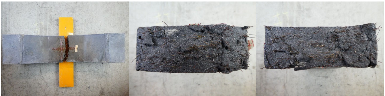
(d)床版 (小) -3 の側面と破断面
