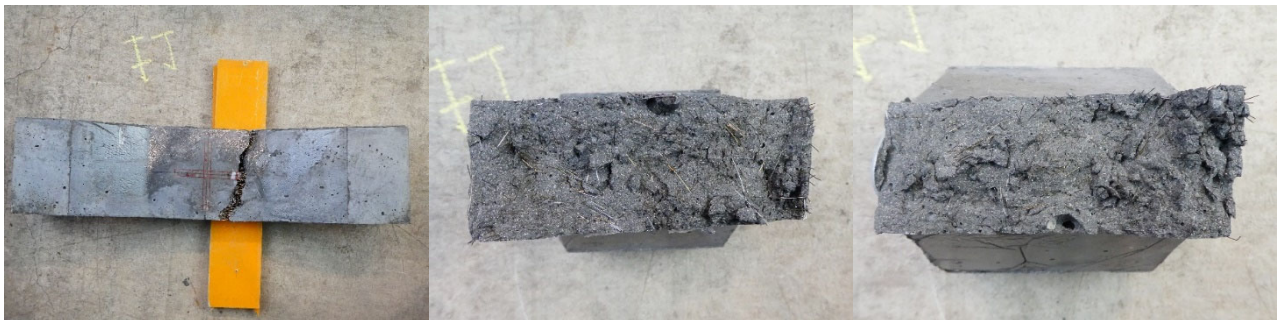
(c)補修材-2 の側面と破断面
