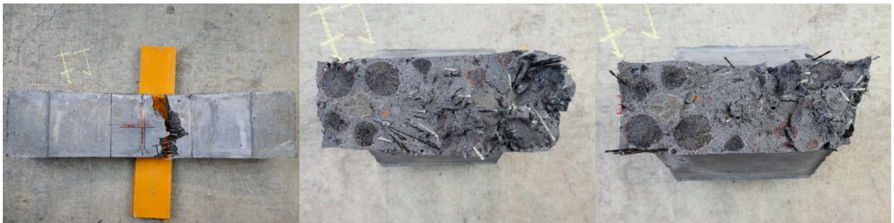
(c)床版-5 の側面と破断面
