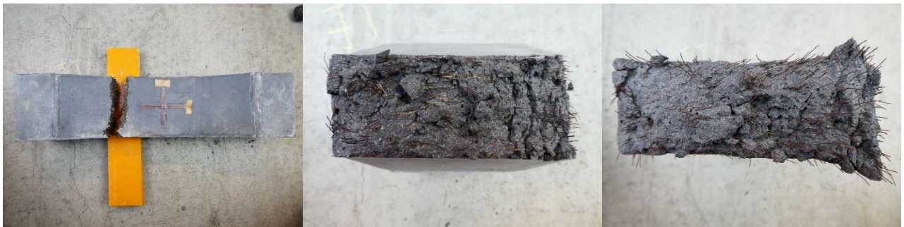
(c)床版 (小) -2 の側面と破断面
