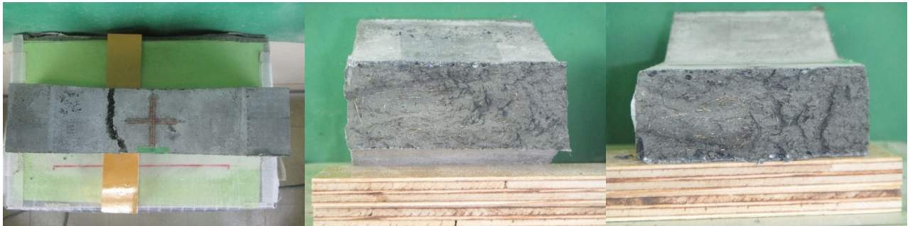
(b)JT-1 の側面と破断面
