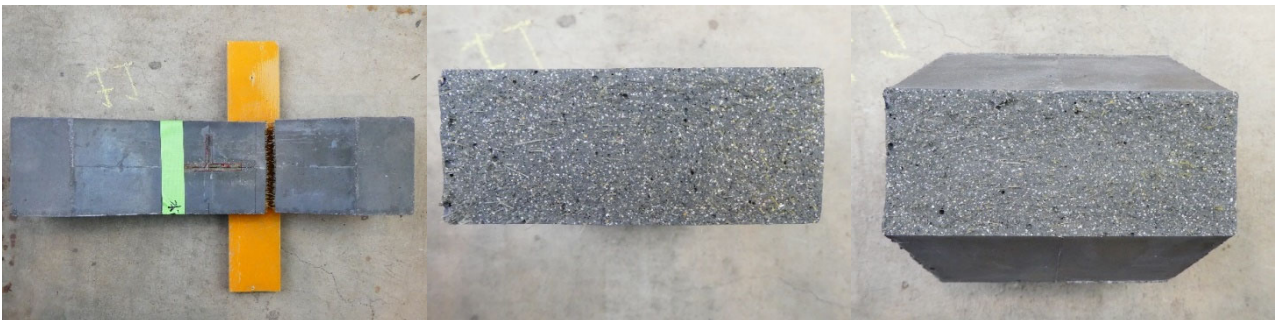
(c)床版-5 の側面と破断面
