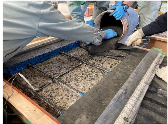
図-1.2.5.4 補修材の施工状況 (KJ)
