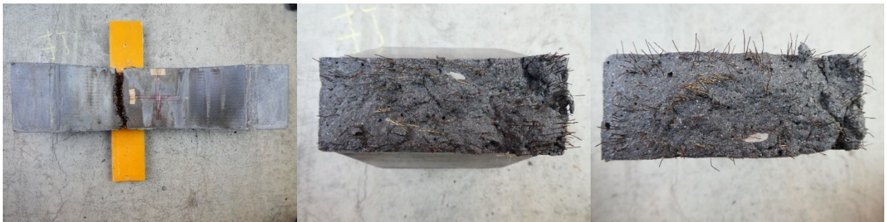
(b)床版 (小) -1 の側面と破断面
