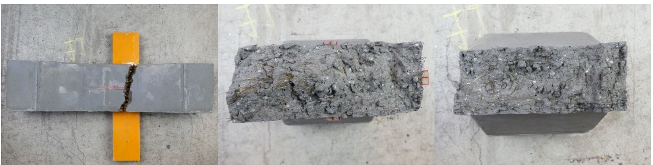
(c)はり(間)-2の側面と破断面
