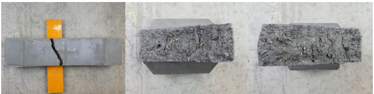
(d)床版(間) -6 の側面と破断面
