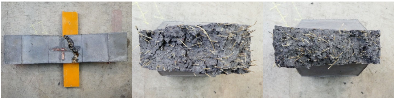
(d)床版 (間) -6 の側面と破断面
