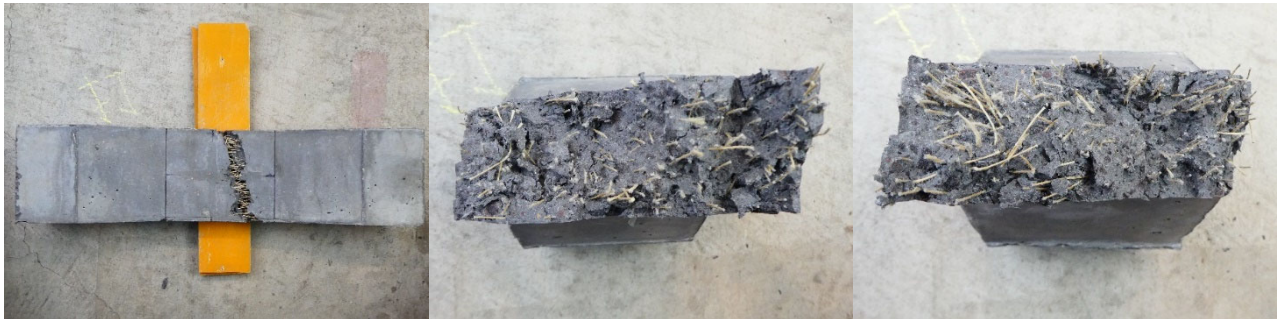
(b)床版 (間) -4 の側面と破断面
