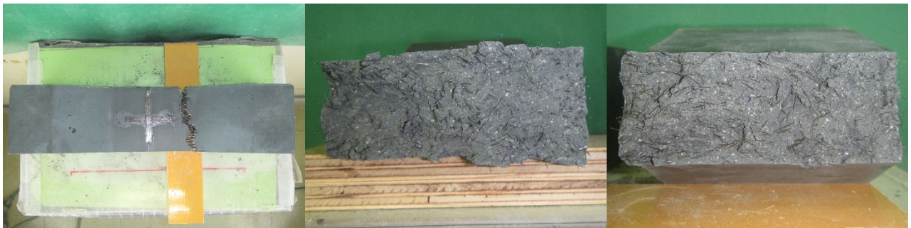
(b)はり (間) -4 の側面と破断面
