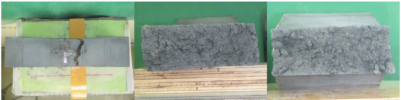
(d)はり-6 の側面と破断面
