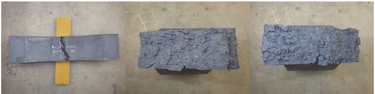
(c)はり (間) -2 の側面と破断面
