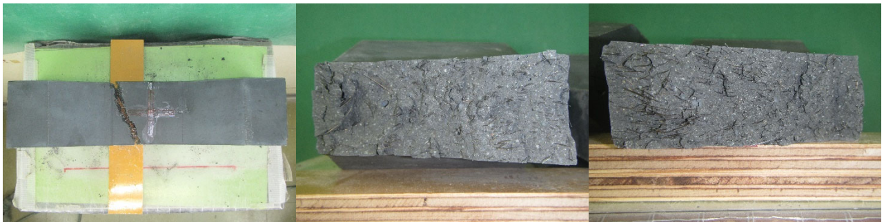
(d)はり (間) -6 の側面と破断面
