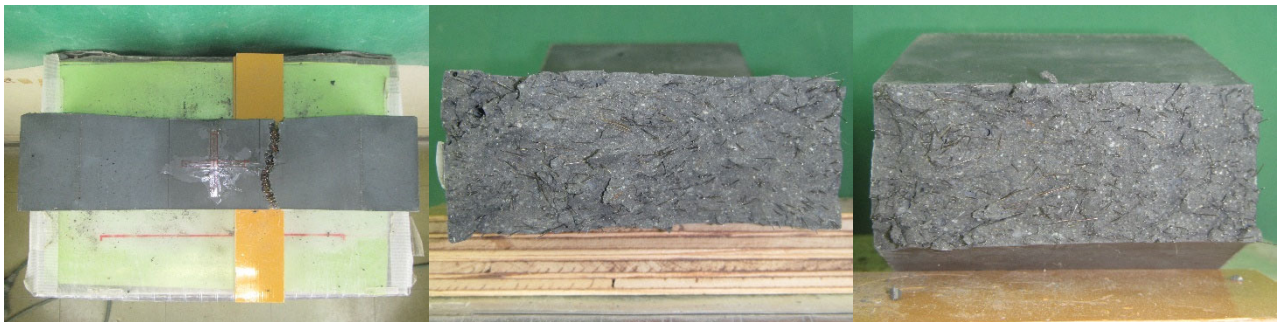
(c)はり (間) -5 の側面と破断面
