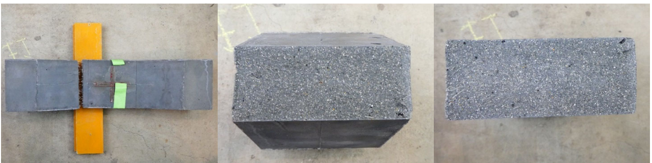
(d)床版-6 の側面と破断面
