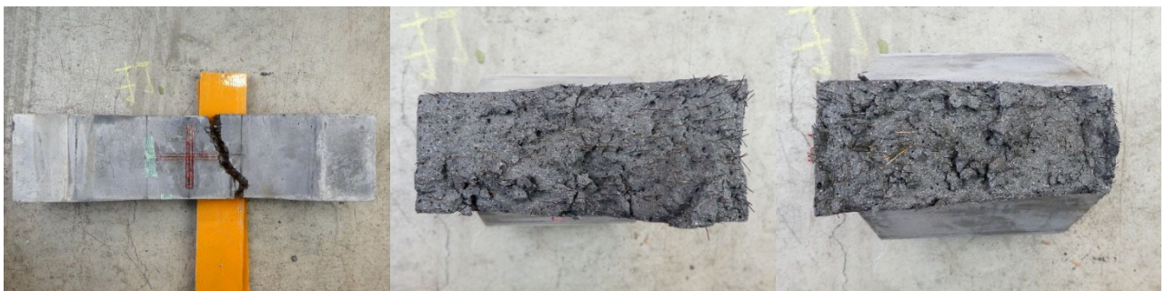
(d)はり-3 の側面と破断面
