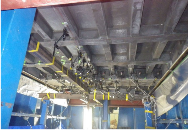
(a) 床版下面の鉛直変位計とパイ型変位計の設置状況（版全体の挙動）
