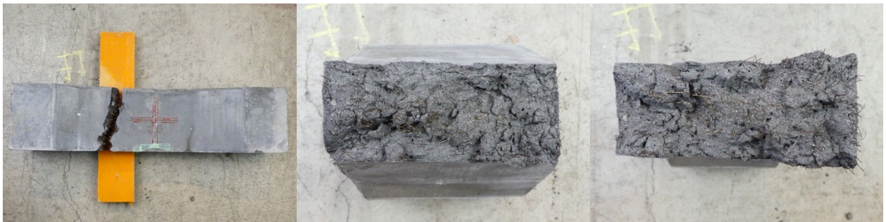
(b)はり-1 の側面と破断面
