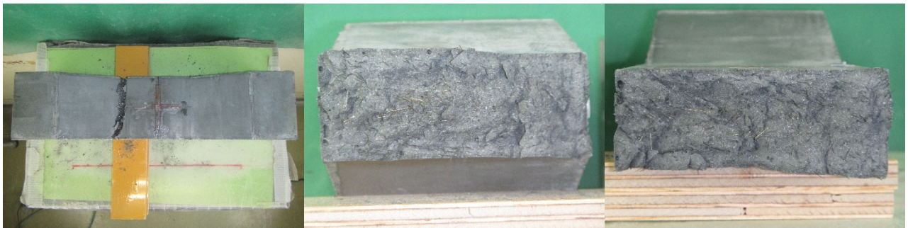
(c)はり-5 の側面と破断面
