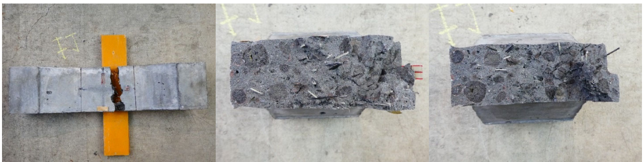
(d)床版-3 の側面と破断面
