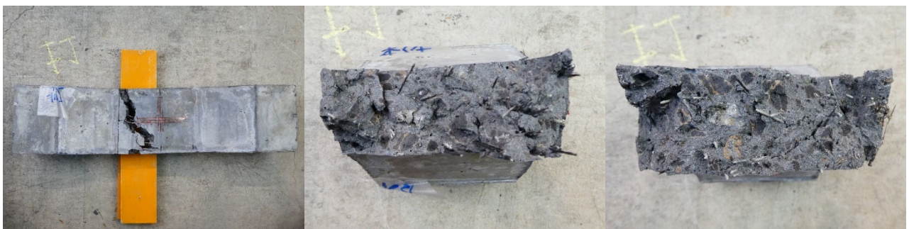
(c)床版-2 の側面と破断面
