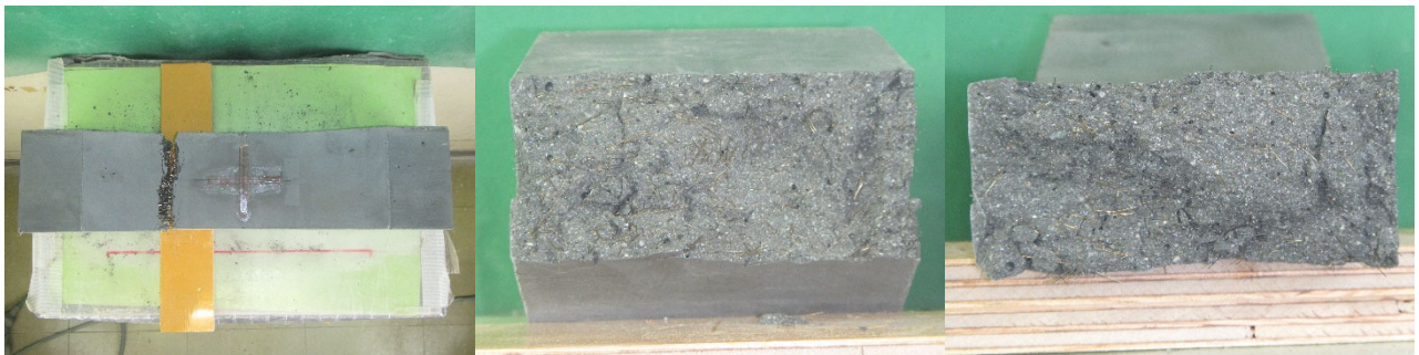
(b)補修材-4 の側面と破断面
