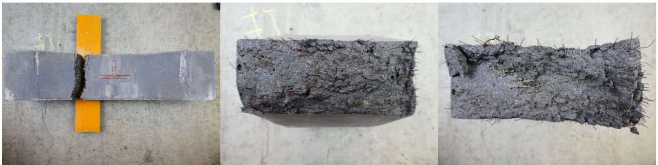
(c)床版 (大) -2 の側面と破断面
