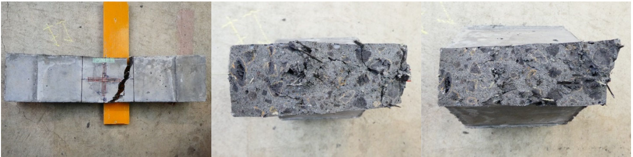
(b)はり-1 の側面と破断面
