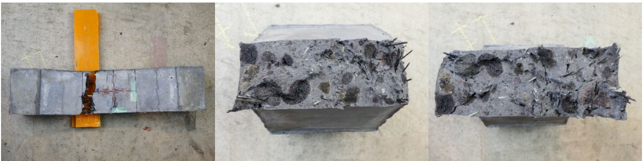
(c)はり-2 の側面と破断面
