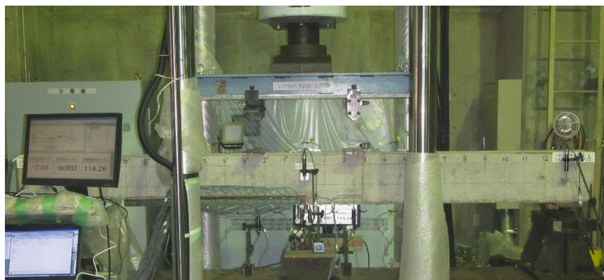
図-3.2.4.1 静的曲げ試験
