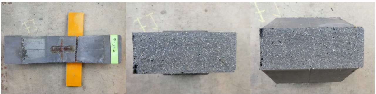
(d)床版(間)-6の側面と破断面
