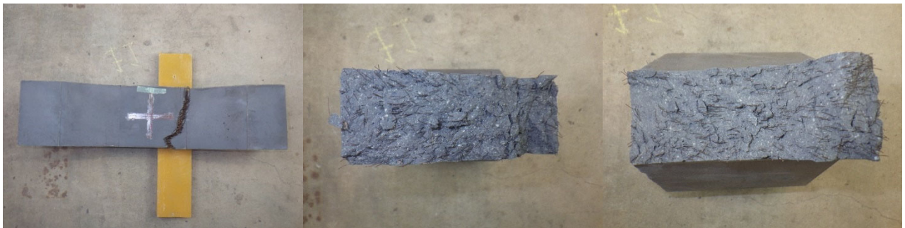
(d)はり (間) -3 の側面と破断面
