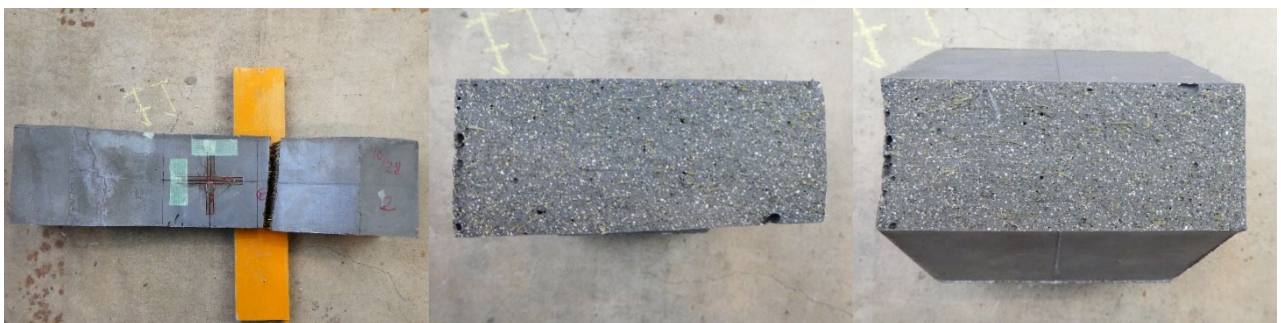
(c)はり-2 の側面と破断面
