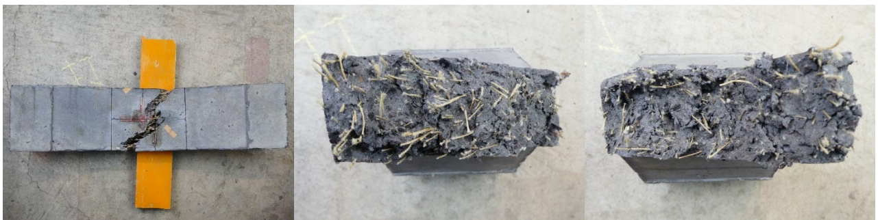
(d)床版 (間) -3 の側面と破断面
