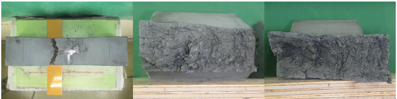
(c)はり-5 の側面と破断面
