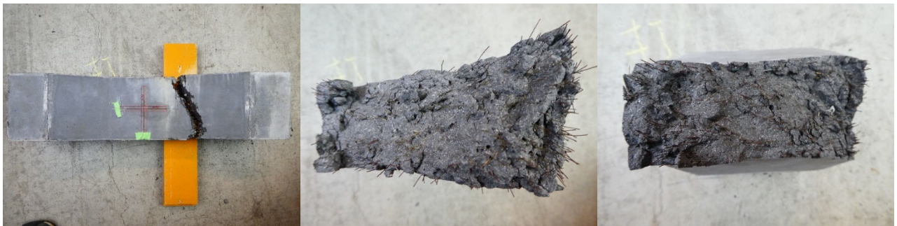
(d)床版 (大) -6 の側面と破断面
