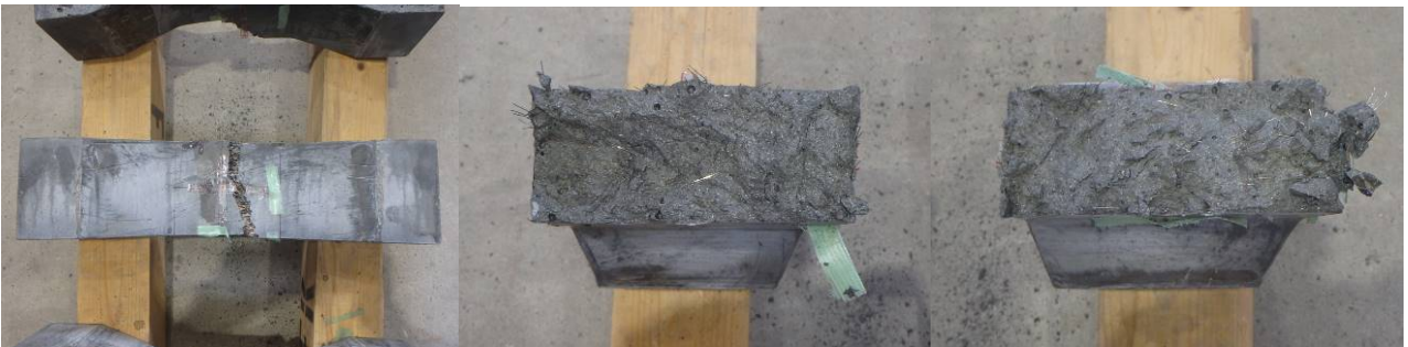
(c) PCa-2 の側面と破断面
