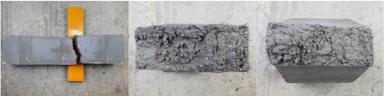
(c)床版(間)-2の側面と破断面
