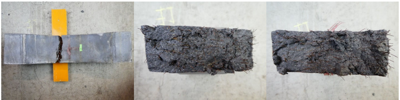
(b)床版 (小) -4 の側面と破断面
