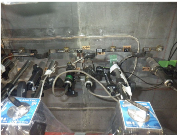
(b) 打継目の開き、段差の測定機器の設置状況（接合部の挙動）
