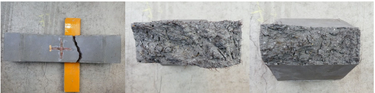
(d)床版(間)-3の側面と破断面
