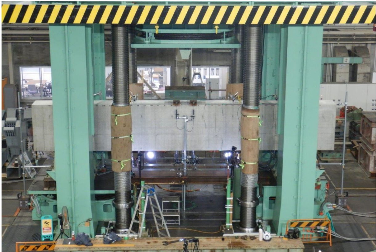
写真 3.2.2.1 載荷試験の状況 (RC-1200)
