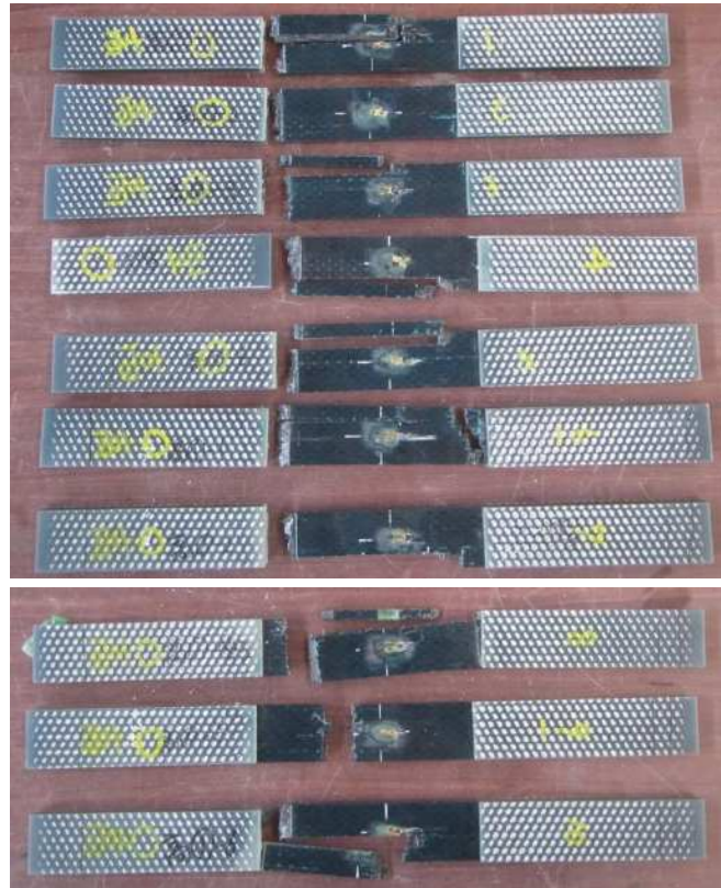
写真 3.3 積層したシートの試験後の試験片（高強度シート）
