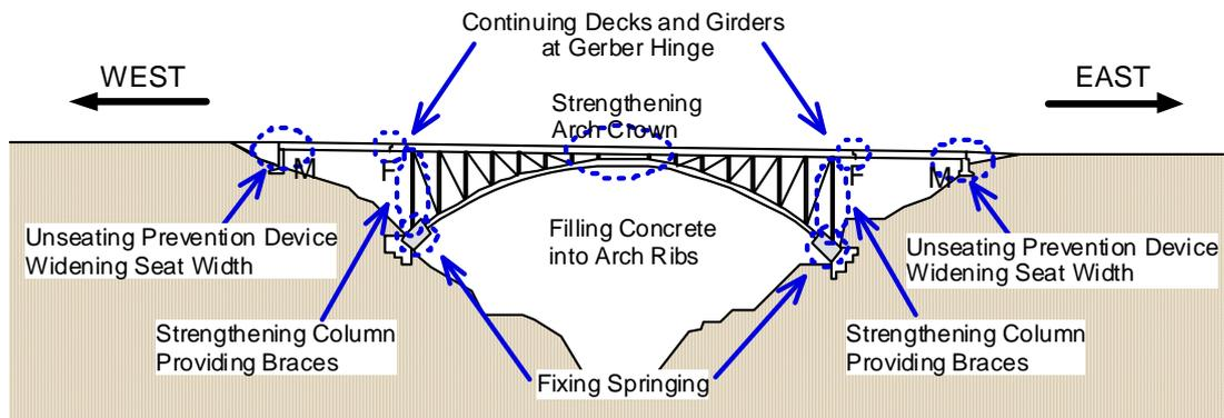
**Figure 2 Seismic retrofit**
