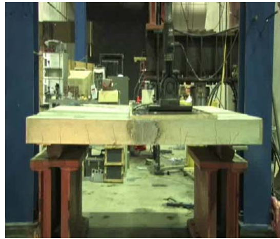
Figure 2 – UHPC deck closure pour
