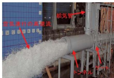
図-5 トンネル内放流設備の水理実験
