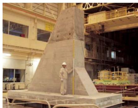
図-1 大型模型振動破壊実験
