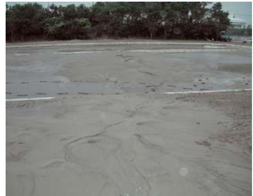
写真-1 地盤の液状化に伴う噴砂
