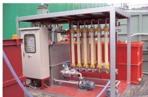
ダイオキシン類に汚染された排水を、環境基準や排水基準まで浄化可能な「カートリッジ式膜モジュールシステム（MFMシステム）」
