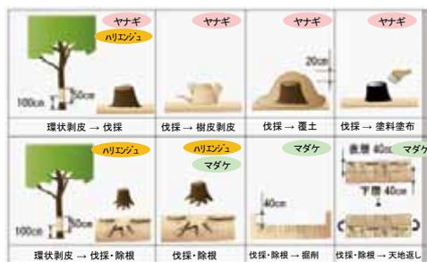
図8.4 主な萌芽再生抑制方法(実験の概要)
