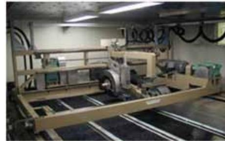
写真 16.1 室内凍結路面走行装置
