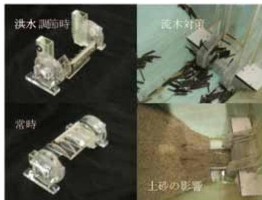
写真 9.4 回転式ゲートの検討概要
