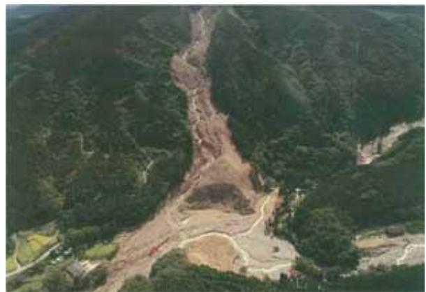
図 2.5 深層崩壊起因土石流の例（宮城県鰐塚山）
