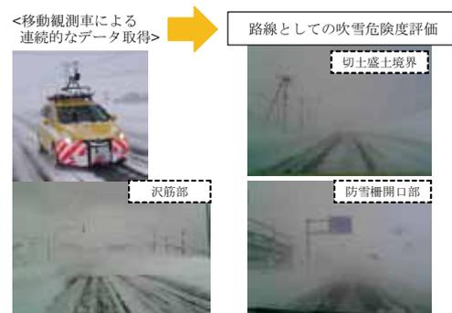
図4.3 吹雪障害の路線としての危険度評価技術の開発
