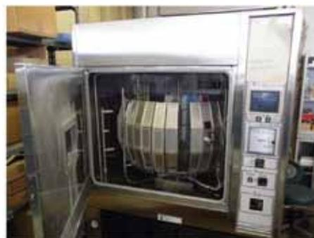
図 15.5 鋼橋塗装の促進耐候性試験（キセノンウェザーメーター）
