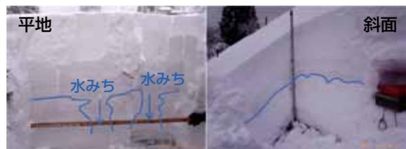
写真 4.2 積雪断面観測による水の浸透状況
