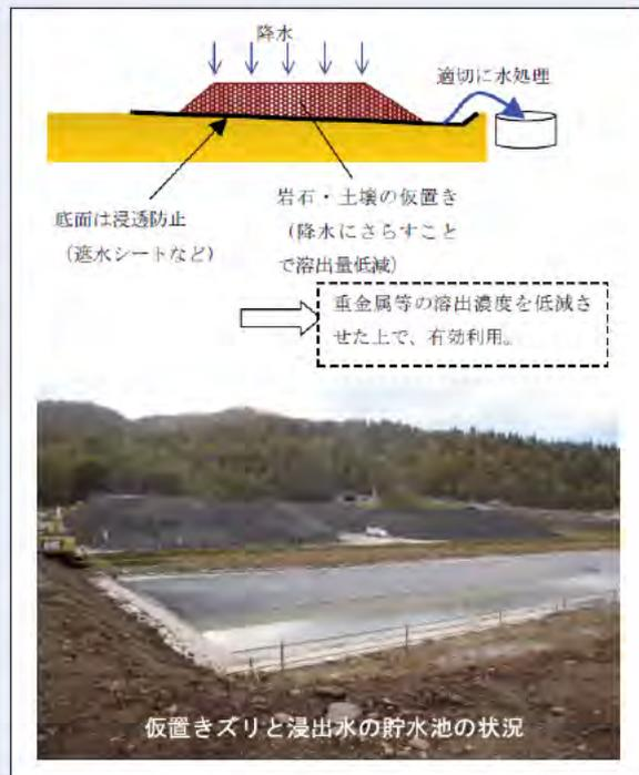
図-1 浸出水処理対策の概念図と事例
