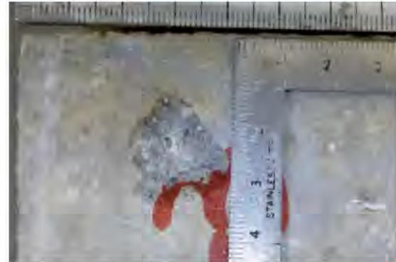
アルカリ量 $2.2\text{kg/m}^3$ の供試体のポップアウト
