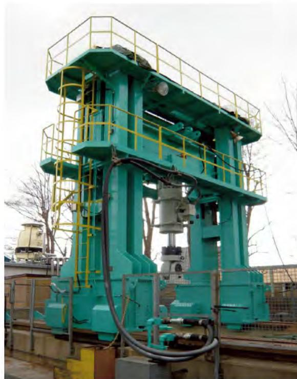
写真 -8.2.2 油圧サーボ試験機
