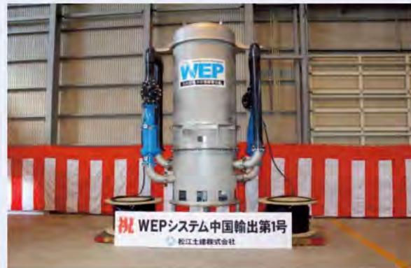
写真-1 気液溶解装置
