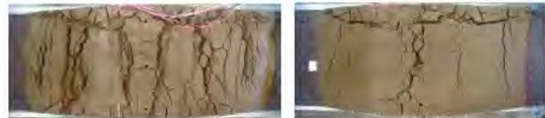
加振後の状況 左写真：基本ケース、右写真：盛土内水位低
