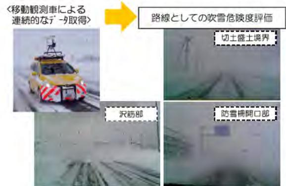
図-4.4 吹雪障害の路線としての危険度評価技術の開発
