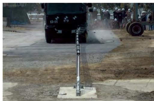
図-16.8 一般道路用柵の性能確認試験
