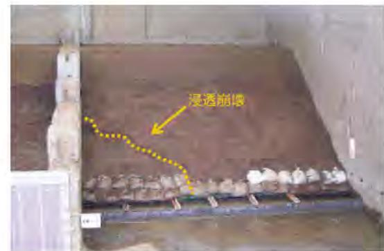
図-3.5 排水効果に関する模型実験（のり尻部の浸透崩壊）
