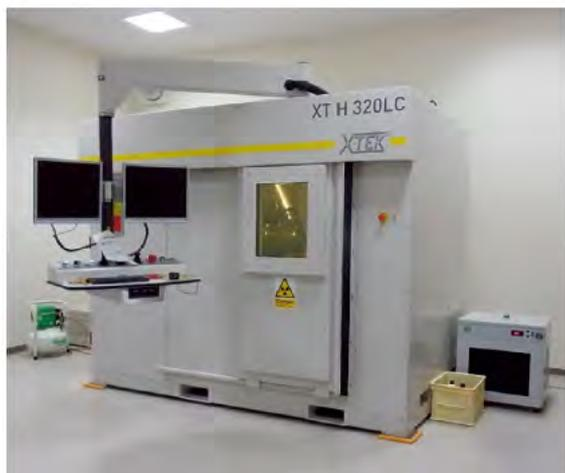
写真 -8.2.1 土木地質材料非破壊分析設備
