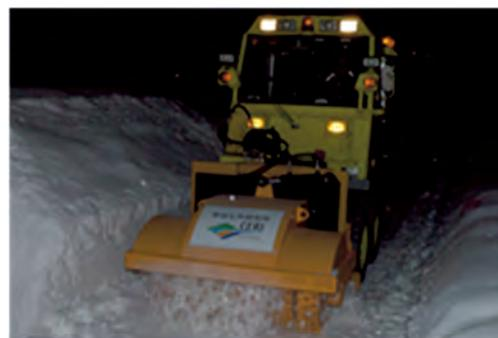
図-16.7 雪氷路面処理装置の性能確認試験
