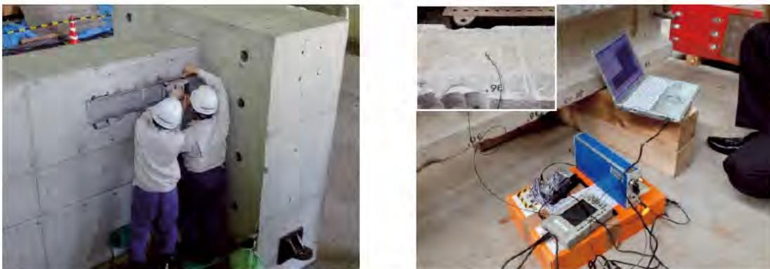
写真-1.5.4 撤去部材などを用いた非破壊検査技術の試行（左：鉄筋破断探査 右：振動計測状況）
