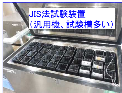
写真-2 耐凍害性の標準試験として普及している JIS A 1148A 法の凍結融解試験機
