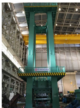
30MN 大型構造部材万能試験機改修（つくば）[H28]
