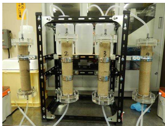
写真-3 上向流カラム通水試験の試験状況
