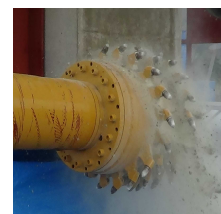
図-8 切削機械の試験施工
