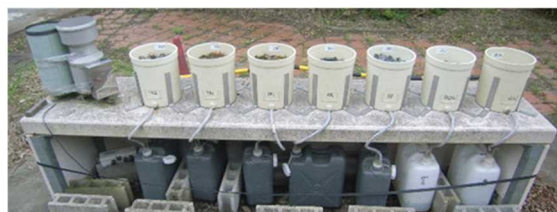
図-5 土研式雨水曝露試験の実施状況
