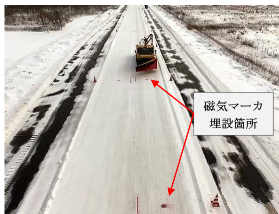
図-2 磁気マーカ埋設区間における除雪車の自動運行補助（苫小牧寒地試験道路）
