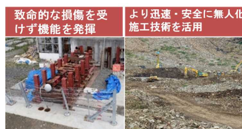
図-3 土砂災害の防止・軽減のための開発技術（左：落石防護柵の載荷実験，右：阿蘇大橋地区
