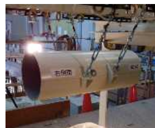
写真-1 吊り金具の破断を再現した模型実験
