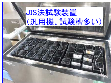
写真-2 耐凍害性の標準試験として普及している JIS A 1148A 法の凍結融解試験機
