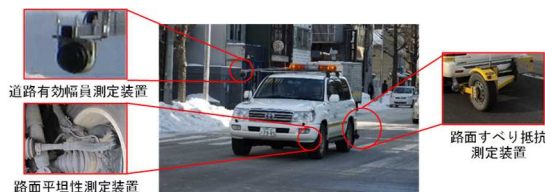
図-5 冬期走行環境計測車両による計測実験
