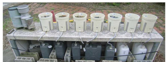
図-5 土研式雨水曝露試験の実施状況
