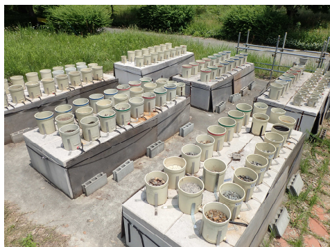
図-1 実態に即した溶出現象評価のための実験の継続的な実施例（土研式雨水曝露試験）
