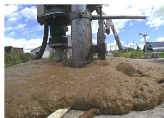
図-10 肥培灌漑施設における泡溢流状況
