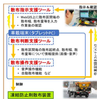
図-9 凍結防止剤散布支援システムの概要
