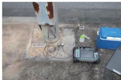
図-7 地中部腐食調査状況
