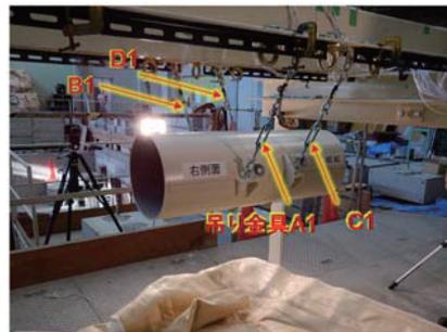
図-6 JF 模型落下実験の状況
