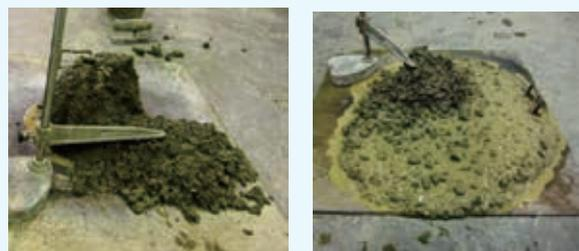
写真-3 材料分離した試料の例（左：セメント量の不足による材料分離，右：化学混和剤の過剰使用によるセメントペーストの分離）
