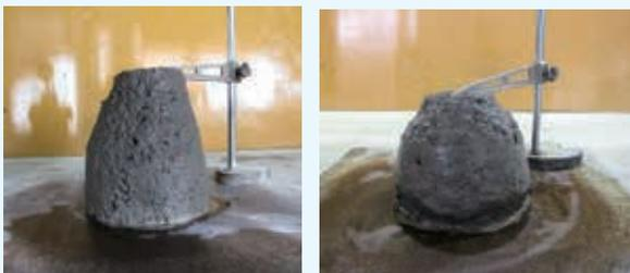
写真-2 スランプ試験後の試料適切な例（左：スランプ約8cm，右：スランプ約12cm）
