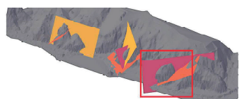
図-3 面構造に基づく想定崩壊箇所
