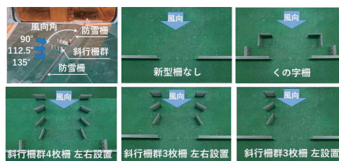
図-12 新型柵の風洞実験
