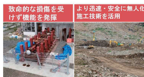
図-3 土砂災害の防止・軽減のための開発技術（左：落石防護柵の載荷実験、右：阿蘇大橋地区）
