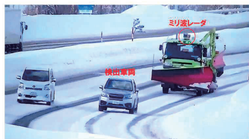
図-14 前方障害物探知ガイダンスの一般国道における実験状況
