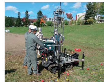
図-10 自走式静的貫入試験装置の概要
