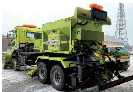
図-7 凍結防止剤自動散布システムを搭載した除雪トラック(散布装置付き)
