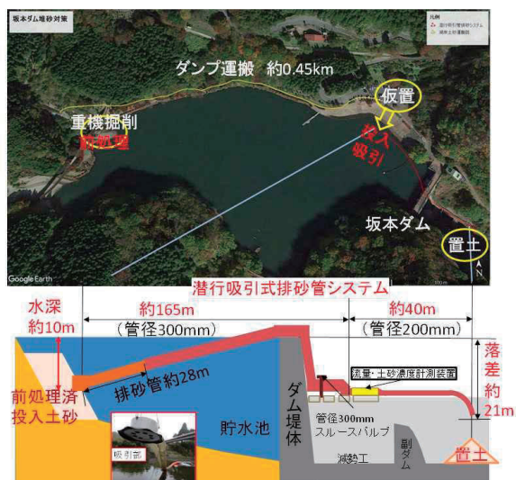
図-1 坂本ダムに設置した排砂管システム
