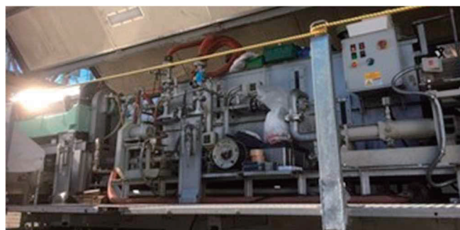
図-5 植物系バイオマス混合脱水試験を行った遠心分離脱水機
