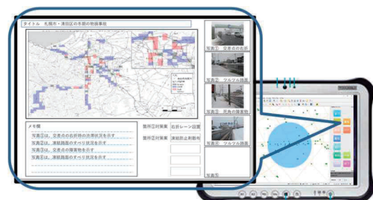
図-10 道路安全診断支援ツール試作品に搭載したエキスパートシステム暫定版の改良
