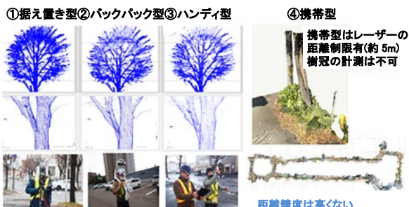
図-2 街路樹の点群データ収集における実用性の比較
