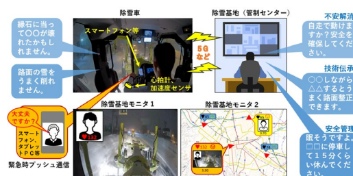
図-2 除雪等機械オペレータ支援システム
