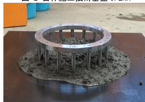
写真-1 高流動性のコンクリートの試験例
