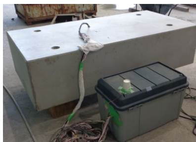
写真-1 プレキャスト工場で作成された温度測定用の試験体
