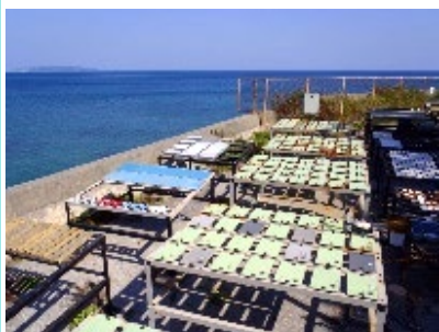
写真-1 暴露試験や促進試験等による防食性・耐候性・長期耐久性の確認
