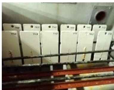
写真-1 暴露試験や促進試験等による防食性・耐候性・長期耐久性の確認
