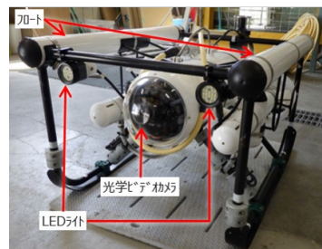
図-4 ROV（水中カメラロボット）の活用
