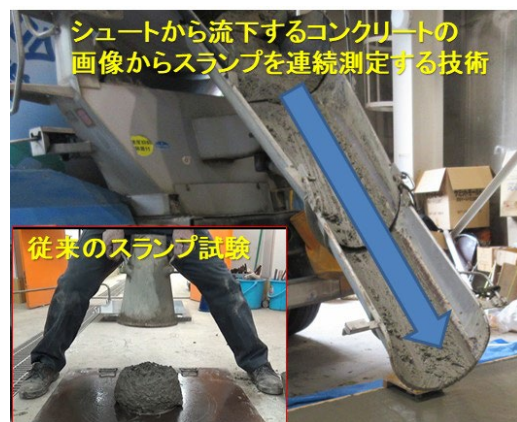
写真-3 画像解析によるスランプの連続測定技術のイメージ
