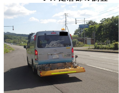
写真-2 RC床版の滞水推定に用いた車載式電磁波レーダ
