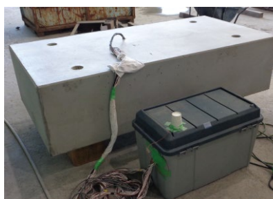
写真-1 プレキャスト工場で作成した温度測定用の試験体
