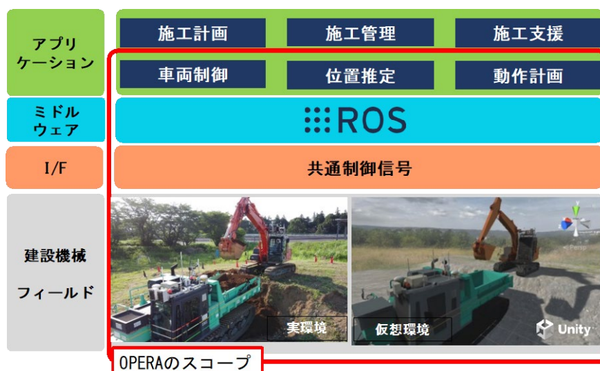
図-1 自律施工技術基盤 OPERA の構成
