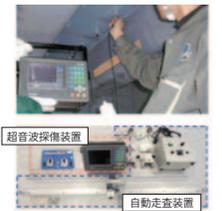
近年、鋼床版橋梁においてデッキプレート内に進展するき裂が見つっています。このき裂は、目視点検では直接確認することが困難な部位に発生するため、超音波探傷による非破壊調査技術が求められています。本講演では、臨界角の斜角探触子を用いて、客観性・信頼性の高い超音波調査技術を開発したのでその概要を紹介します。
