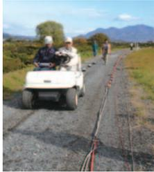
河川堤防は洪水時にも浸透や浸食によって破壊しない強度を有していることが求められますが、外見だけでは強度に問題がある部分を抽出することが困難です。そこで堤防内部の構造と物性分布をイメージし、弱点箇所を効率的に抽出することが可能な物理探査手法を開発し、現場での普及を図っています。本発表では電気探査と表面波探査を組み合わせ適用する統合物理探査技術について、実施事例を交えて紹介します。
