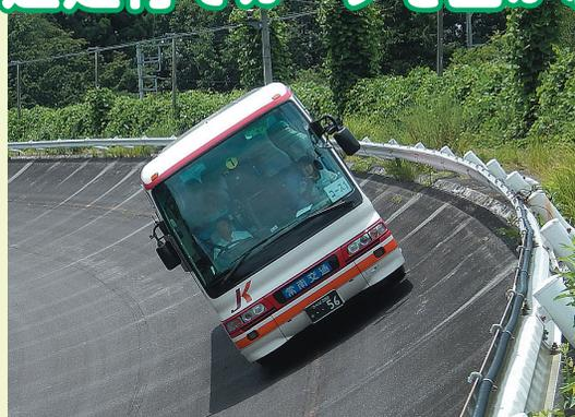
実験用走路の角度約30度（スキー上級者コース並み）のバンクをバスが時速およそ100Kmで走りぬけます。
