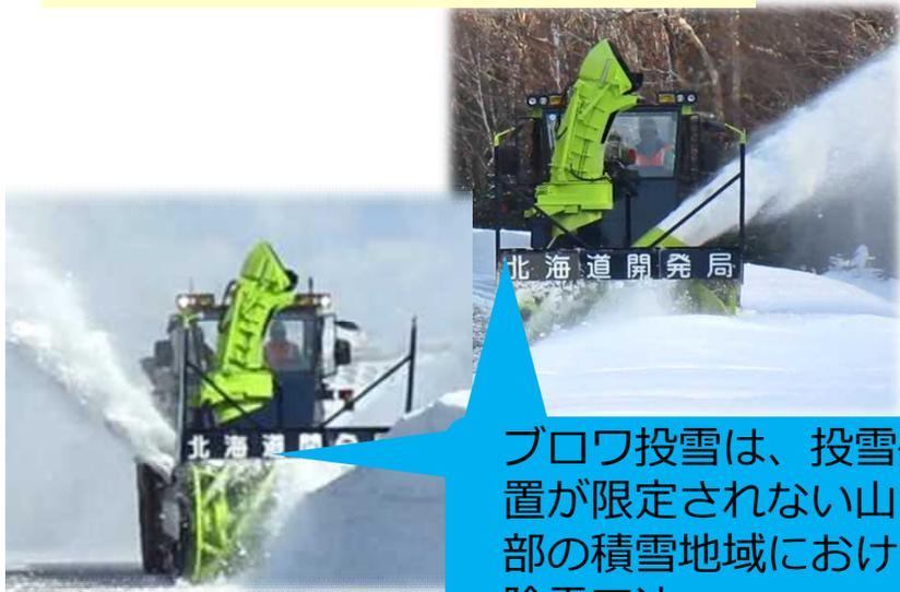
ブロワ投雪は、投雪位置が限定されない山間部の積雪地域における除雪工法。ブロワの回転速度で投雪距離を調整できる。
