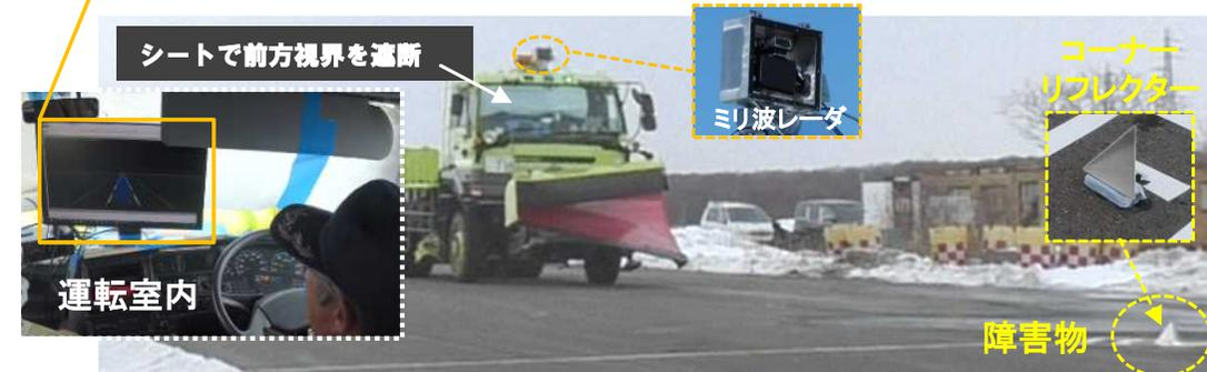
▲前方障害物探知ガイダンスによる停止実験状況
