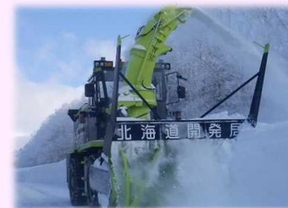
シュート投雪は、投雪方向を案内する装置。投雪角度や方向を調整し、より正確に投雪位置を調整できる。
