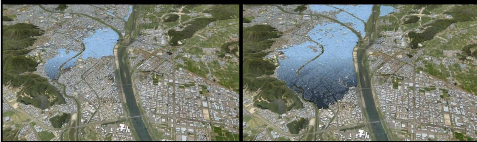
城北地区が最大浸水深となる場合の浸水シミュレーションの可視化:破堤20分後
