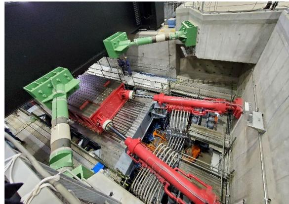
図-1 実大試験機の概要(出典: 免震技術・制振技術の更なる発展のために)
