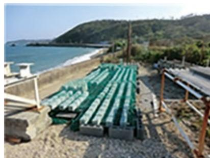
コンクリートの暴露試験実施状況
