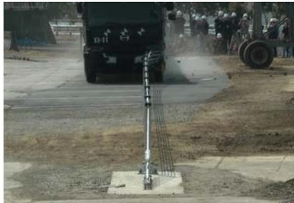
写真-2 大型車による衝突試験
