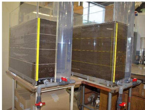
写真-1 転作時の地下水位管理手法解明のための室内実験装置
