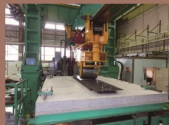
床版模型の疲労耐久性試験の様子。世界でも有数の疲労載荷試験機により、実規模試験を基にした開発技術の検証を行っています。
