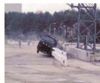
防護柵開発のための衝突実験
