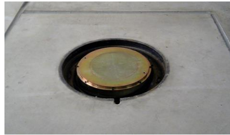
写真2 荷重計較正用ロードセル
