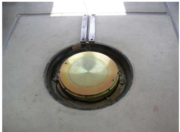
図-2 荷重検定用ロードセル
