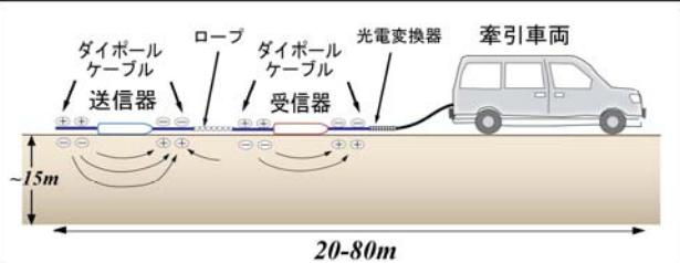
■ 送信部の2つのキャパシター電極に逆の電荷を与えると、地盤との間にコンデンサーが形成され地盤に電流が流れ、これにより受信部側付近の地盤にも電流が流れるので、受信部のキャパシター電極と地盤の間にもコンデンサーが形成され、受振部の2つの電極間に電位差が発生する。この電位差から比抵抗分布を求める。
