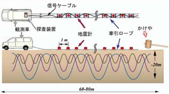
■ 波長によって伝播する深さが異なり、速度も異なるという表面波の分散特性に基づいて地下のS波速度構造を推定する手法
