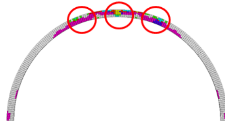
図-6 数値解析による覆工載荷実験の再現（破壊領域図）
