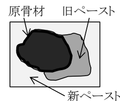
(2) 再生骨材コンクリート
