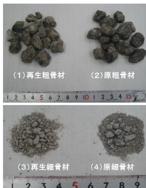
写真-2.1 再生骨材と原骨材
