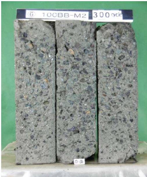
写真-3.1 凍結融解試験後の供試体の劣化状況
