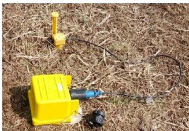
図-10 独立型振動受振装置
