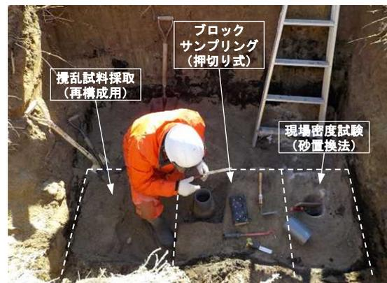
図-2.2 箇所 No.2 のブロックサンプリング状況
