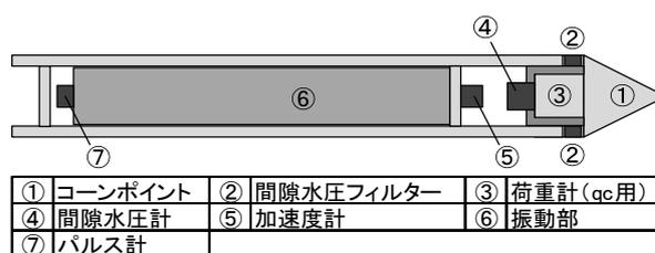
図-3.1 振動式コーンのプローブの全体概要
