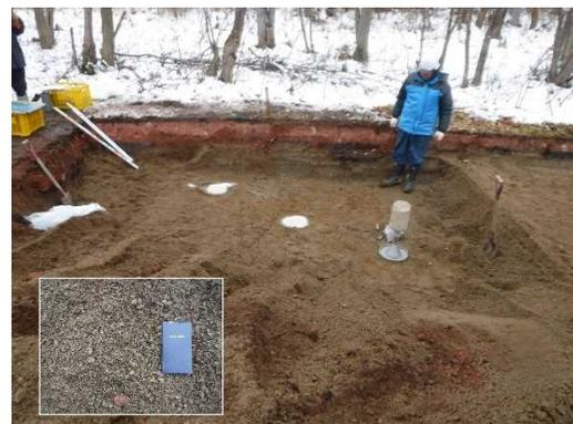
図-2.10 攪乱試料採取箇所の状況
