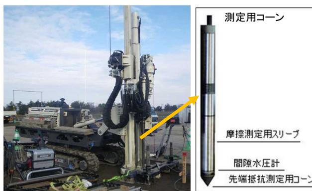
図-1 電気式静的コーン貫入試験機
