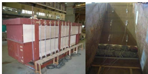
写真 2.1 実験に使用した土槽と構築した盛土
