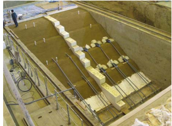
写真 3.1 構築した実大盛土
