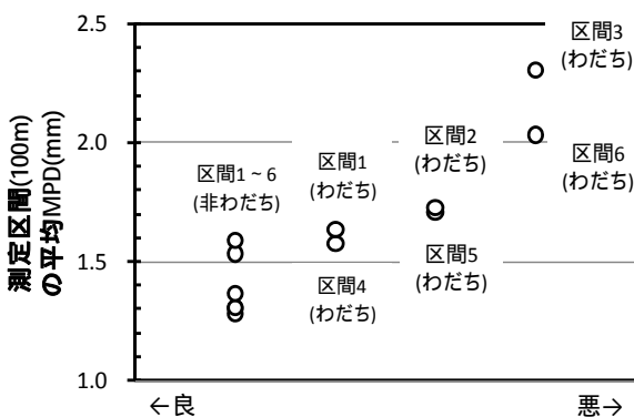
目視による骨材飛散程度の定性的な評価 図-18 目視評価とMPD測定結果の比較
